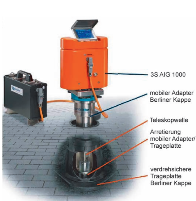
Bild 2: Schaubild System Berliner Kappe®
