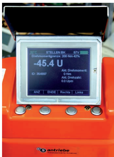
Bild 6: Das 3S AIG 1000 erfasst die Gangzahl einer Armatur auf die Nachkommastelle genau
